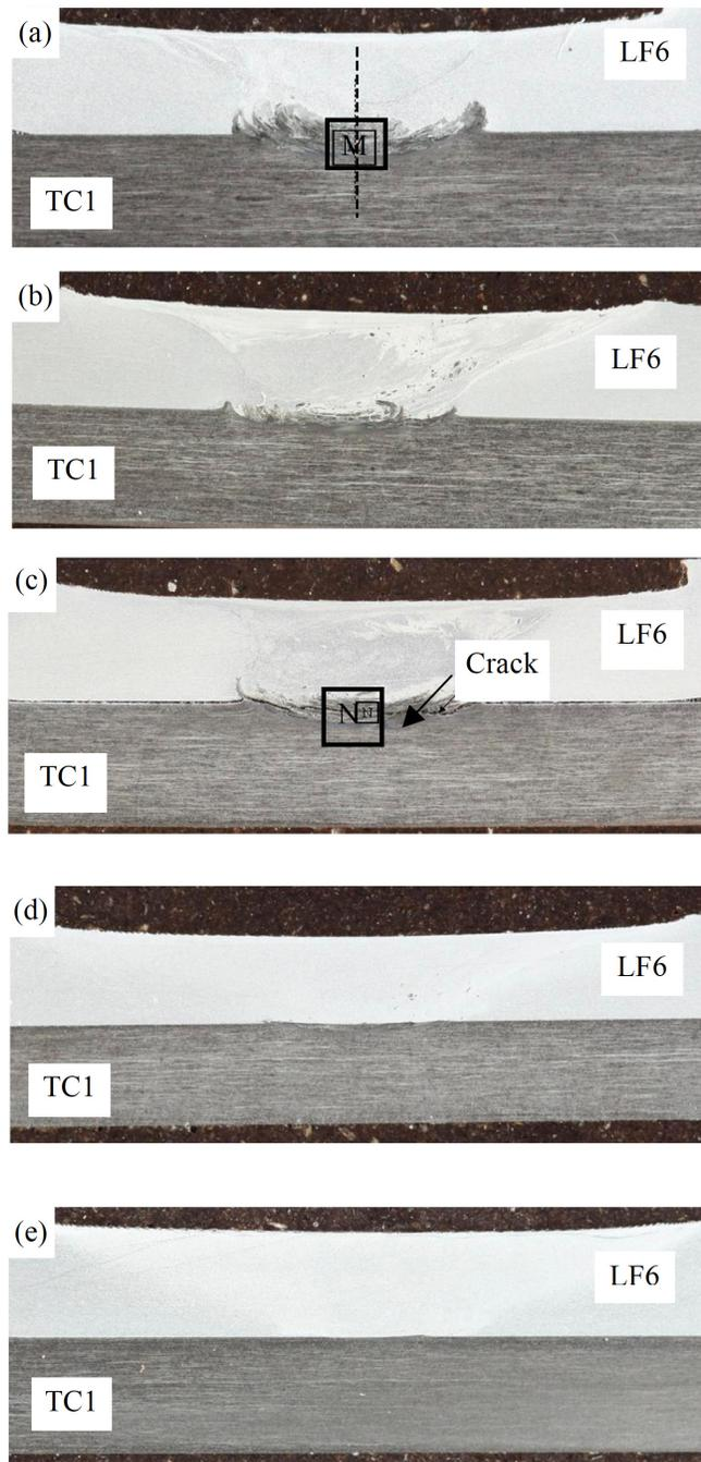
**Fig. (8).** The macroscopic morphology of cross section of lap joint of Ti/Al dissimilar alloys: (a)  $n=1500\text{r/min}$ ,  $v=60\text{mm/min}$ ; (b)  $n=1500\text{r/min}$ ,  $v=118\text{mm/min}$ ; (c)  $n=1500\text{r/min}$ ,  $v=150\text{mm/min}$ ; (d)  $n=950\text{r/min}$ ,  $v=95\text{mm/min}$ ; (e)  $n=600\text{r/min}$ ,  $v=95\text{mm/min}$ .
