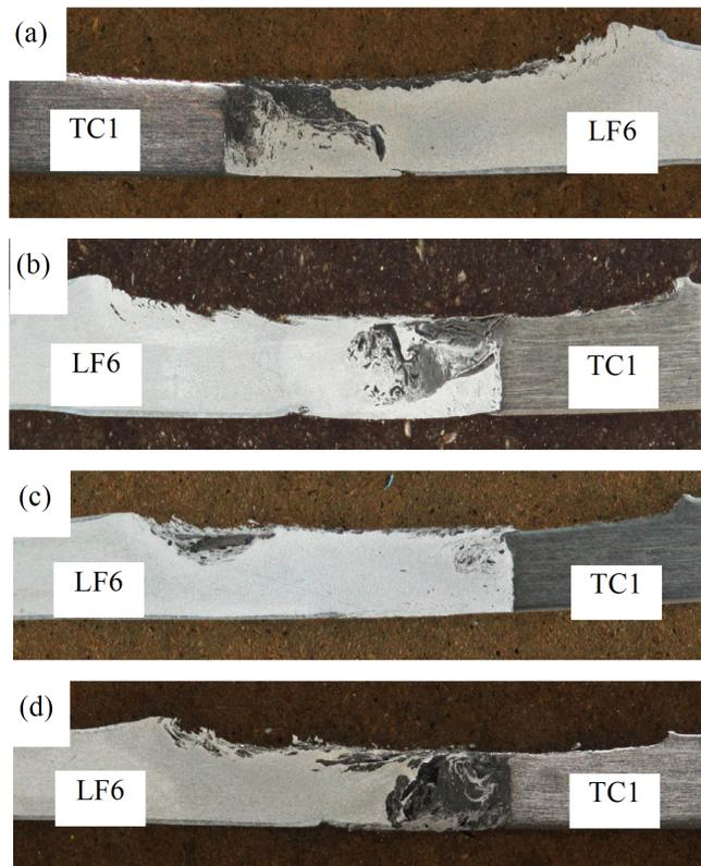
Fig. (6). The macroscopic morphology of cross section of butt joint: (a)  $n=750\text{r/min}$ ,  $v=118\text{mm/min}$ ; (b)  $n=750\text{r/min}$ ,  $v=150\text{mm/min}$ ; (c)  $n=950\text{r/min}$ ,  $v=118\text{mm/min}$ ; (d)  $n=950\text{r/min}$ ,  $v=150\text{mm/min}$ .
