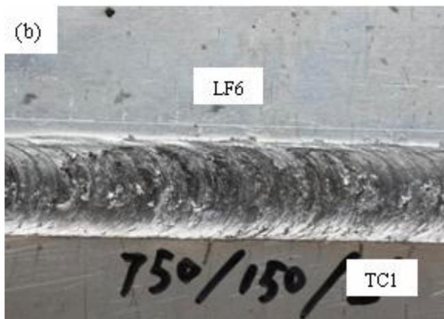
**Fig. (4).** Surface morphology of butt joint of 750r/min: (a)  $v=118\text{mm/min}$ ; (b)  $v=150\text{mm/min}$ .
