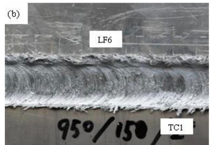
**Fig. (5).** Surface morphology of butt joint of 950r/min: (a)  $v=118\text{mm/min}$ ; (b)  $v=150\text{mm/min}$ .
